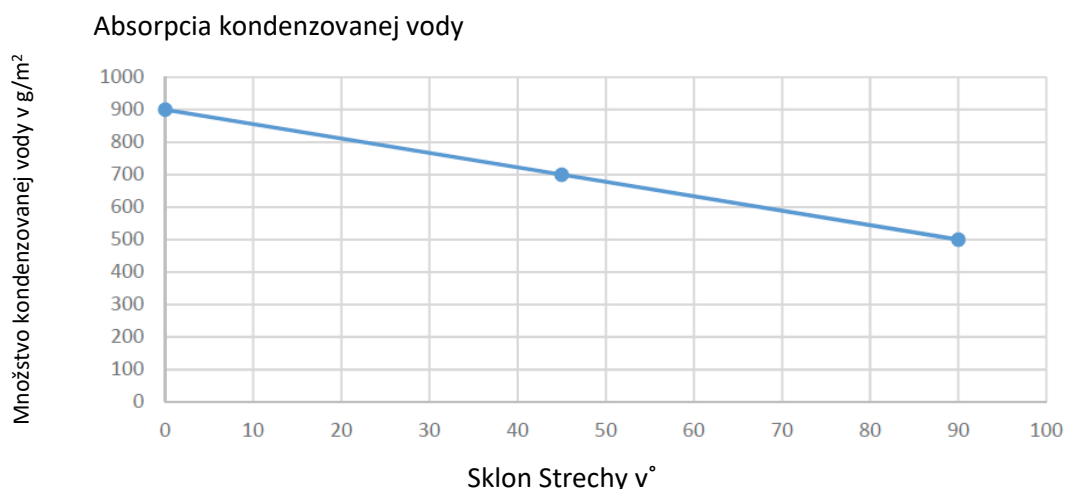
Obrázok 2: Schopnosť zachytenia kondenzovanej vody v závislosti od sklonu strechy
